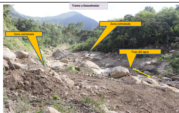
Figura N° 02: Tramo crítico (colmatado) en la quebrada El Limon, en la temporada de maximas avenidas hace desastres y daños a defensas ribereñas, la cual puede afectar a la población aledaños y agricultura, en el sector Canchaque, vulnerable a la velocidades erosivas de la quebrada, Prog. 4+120 - 4+280.
